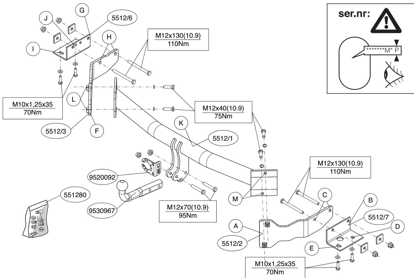
8. Установить поперечный брус К между опорами А и F в точках L и M, затянув крепежный материал не до конца.
